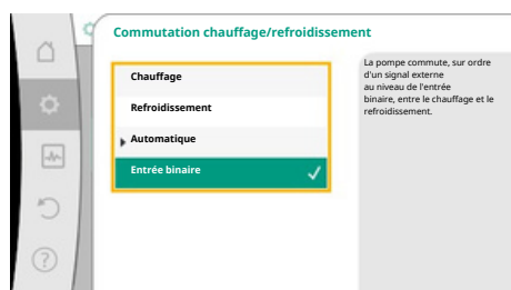
Fig. 53: Commutation Chauffage/refroidissement_Entrée binaire
