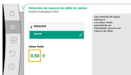
Fig. 79: Valeur limite de la rupture de câble
