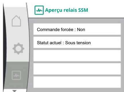
Fig. 94: Aperçu de la Fonction relais SSM
