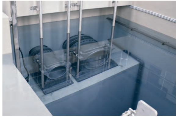
Un banc d'essai dernière génération, permet de tester les pompes avant leur livraison.
